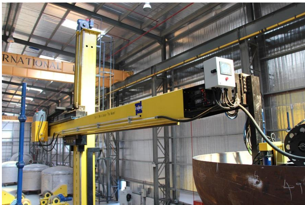
图 5：时代带极堆焊中央控制器现场应用
