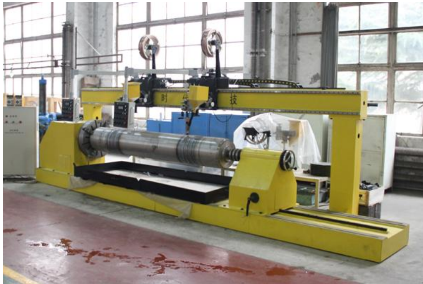
图 3：轧辊多枪埋弧堆焊
